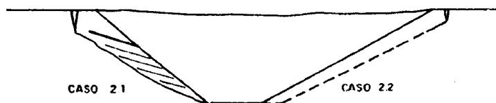
d) TALUDES TIPO 2 A COMPROBAR : ROTURA EN ARENISCAS-PIZARRAS
