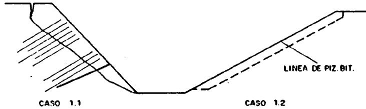
b) TALUDES TIPO 1 A COMPROBAR : ROTURA EN ARENISCAS-PIZARRAS
